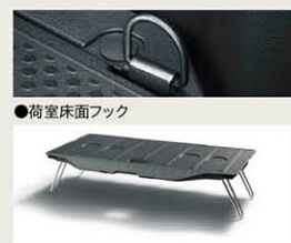
●上下2段階調節式デッキボード(固定フック付) ※Gターボ"VS SA III"は標準装備。
