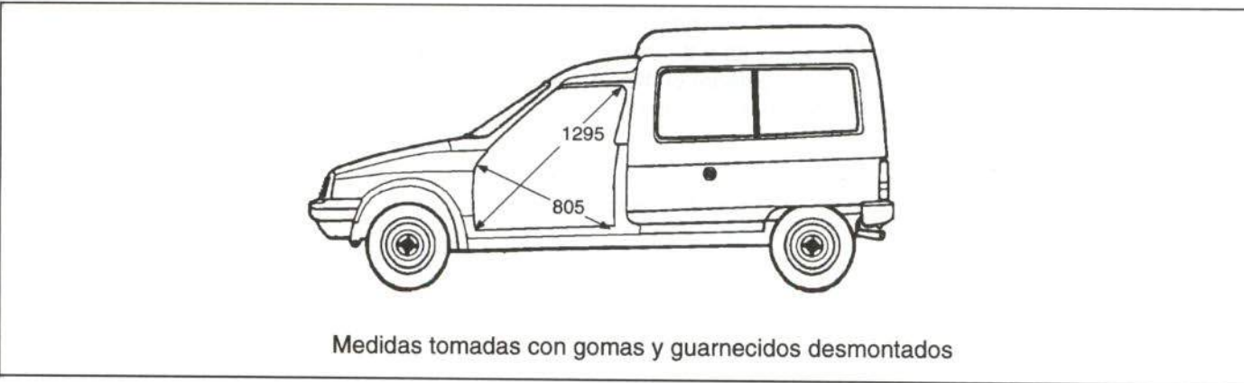
Figura 6.- Medidas de los huecos de puerta
