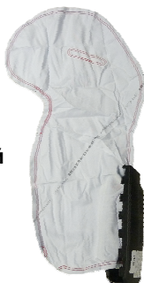
подушки безопасности для защиты головы и грудной клетки водителя и переднего пассажира
