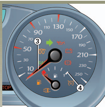
Tachometer (km alebo míle za hodinu) 3
