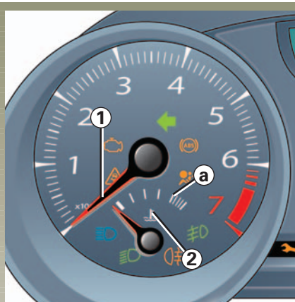
Otáčkomer 1 (dieliky na stupnici \times 1000 )
