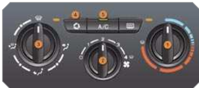
Frontpanel med elektrisk styring
