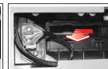
3. Extraiga la cubierta del filtro mientras jala del soporte en la dirección indicada por la flecha. 4. Retire el primer filtro. 5. Mueva suavemente el segundo filtro hacia la izquierda y retírelo. 6. Reemplace los filtros por otros nuevos. Instale en el orden inverso a cuando los extrajo. Asegúrese de que los filtros estén colocados en la dirección correcta.
