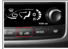
Interruptor AQS (sistema de calidad de aire) y selección de fuente de aire
