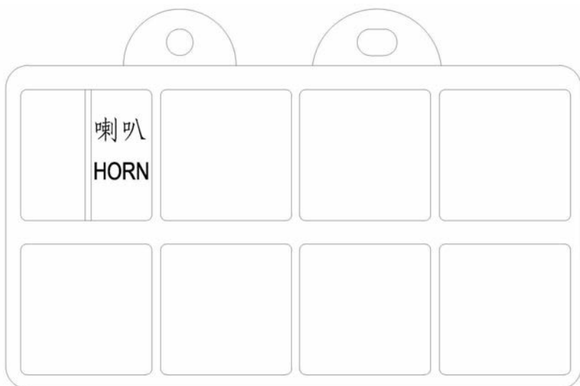
H15T/D20T发动机盖继电器盒内继电器分布图
