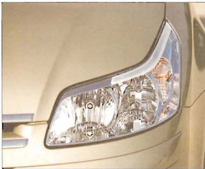
Selon le niveau d'équipement, les projecteurs de la C4 utilisent la technologie couplée xénon/halogène (à gauche) ou intégralement halogène dans des optiques à surface complexe (à droite).
