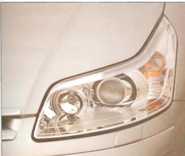
Selon le niveau d'équipement, les projecteurs de la C4 utilisent la technologie couplée xénon/halogène (à gauche) ou intégralement halogène dans des optiques à surface complexe (à droite).
