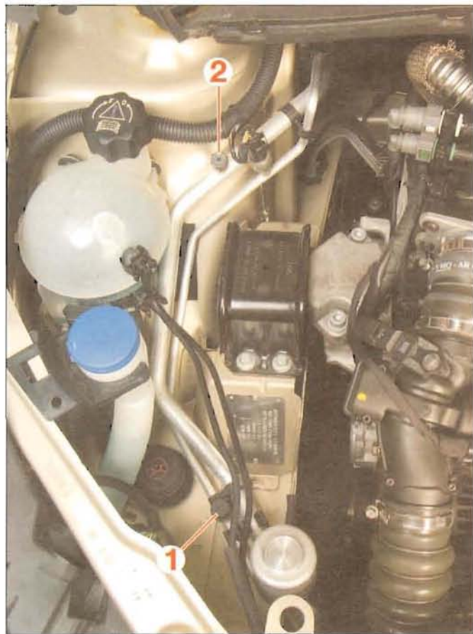
SITUATION DES RACCORDS DE SERVICE HAUTE (1) ET BASSE (2) PRESSION DU CIRCUIT DE CLIMATISATION
