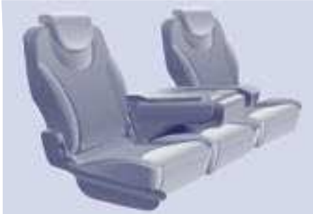
Typ 3: Sitzfläche mit zwei Plätzen, individuell neigungsverstellbare, nach vorne umklappbare Rückenlehnen, Sitzfläche kippbar.
