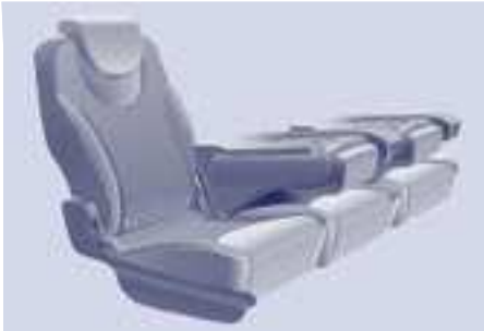
Typ 2: Sitzfläche mit zwei Plätzen, nach vorne umklappbare Rückenlehnen, Sitzfläche kippbar.
