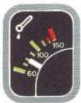
מד טמפרטורת שמן בתנאי נסיעה קשים או באקלים חם, המחוג עשוי להתקרב לסימנים האדומים. בשום מקרה אסור לו להגיע ל-150. עצור את המכונית ואם יש צורך, כבה את המנוע. בדוק את גובה נוזל הקירור של מנוע (ראה עמודים 52-68).
