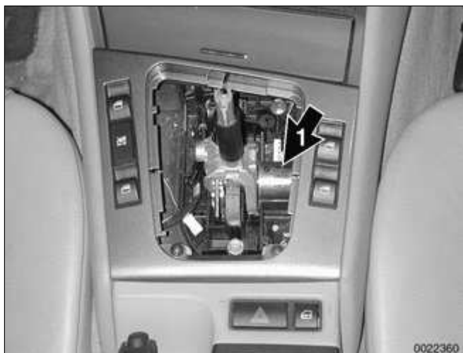
Fig. 46 Under shifter bezel 1 - Shiftlock solenoid
