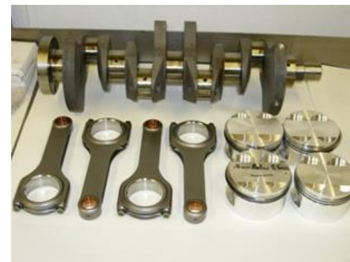
Pistões e Bielas de competição para Twin Spark
