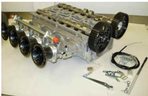
Cabeçote Twin Spark e corpo de borboletas preparado
