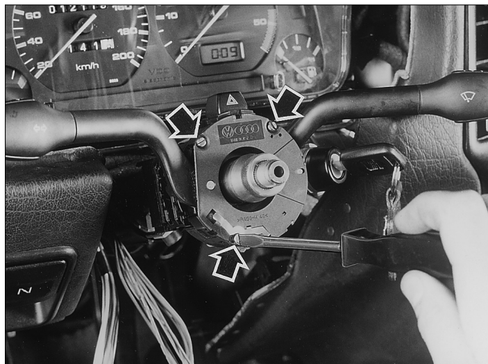
Desmontaje del salpicadero (foto ETAI). Tornillos de fijación de la caja de conmutación.
