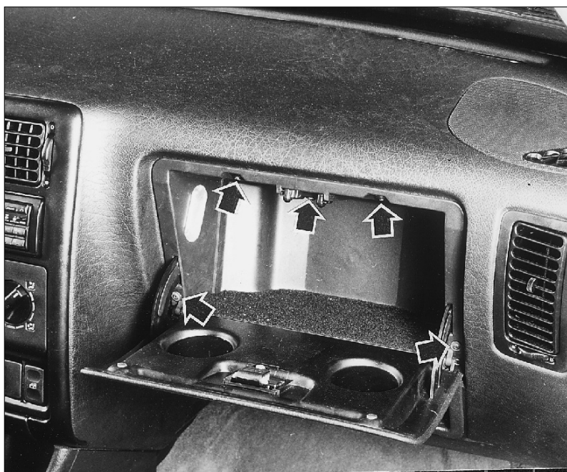
Desmontaje del salpicadero (foto ETAI). Tornillos de fijación de la guantera derecha.
