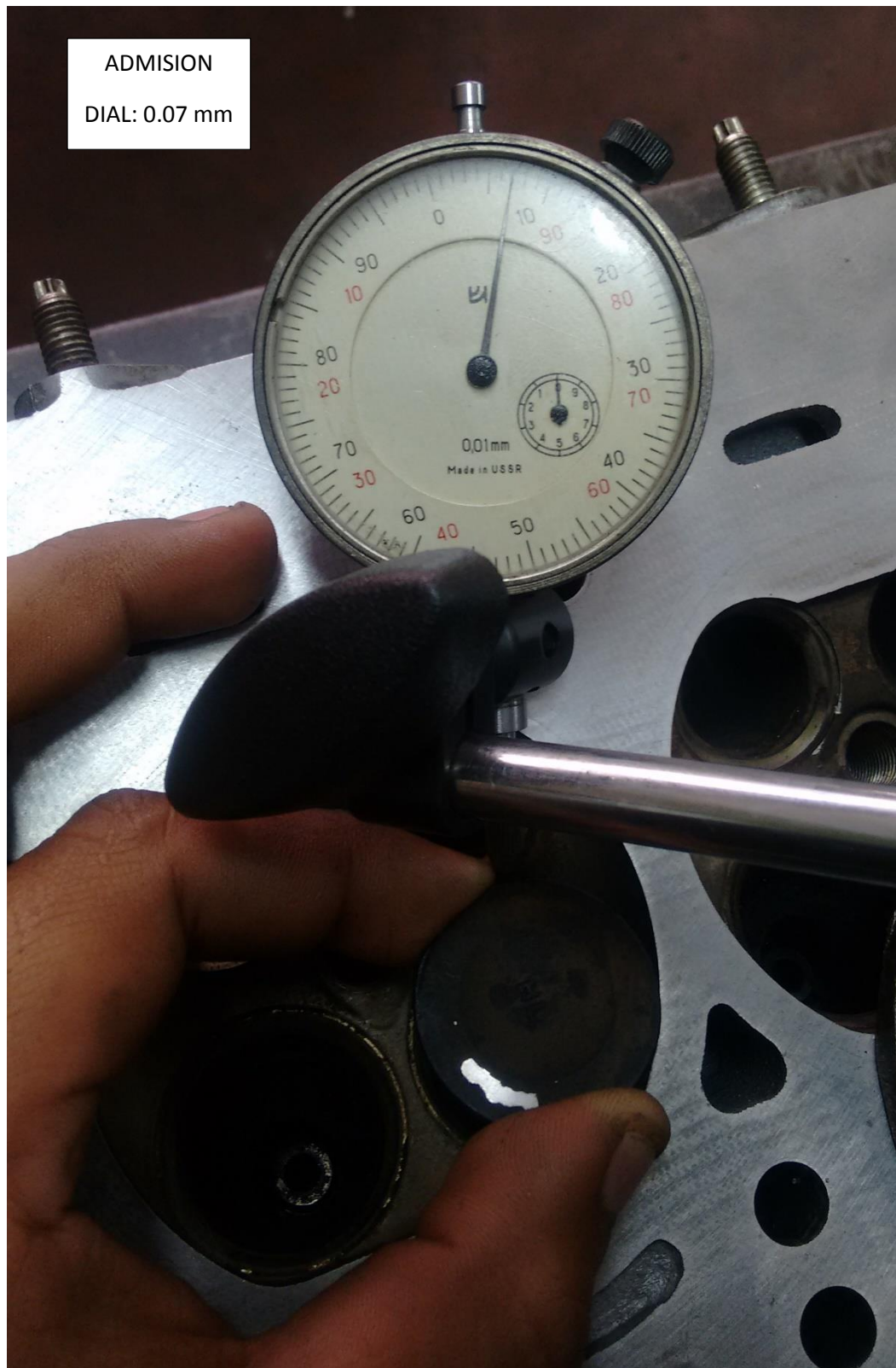
Holgura de guía de válvula de admisión es: 0.07 mm
