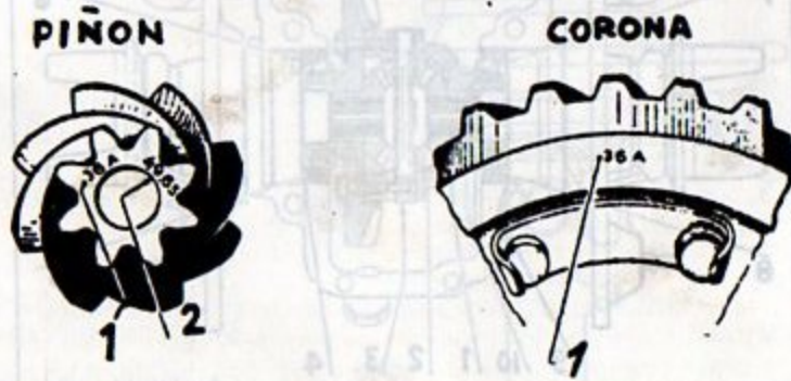
FIG. 44. Codificación de piñón y corona (referencias para emparejamiento). 1: número de emparejamiento; 2: cota de reglaje de este piñón.
