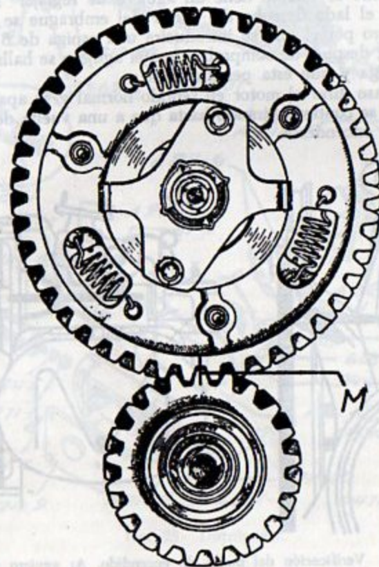
FIG. 20. Puesta a punto de la distribución. M: coincidencia de marcas.
