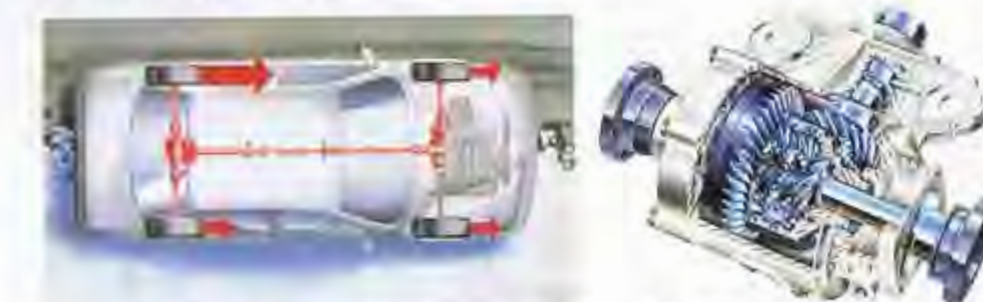
トルセン・デファレンシャルはリアホイールにかかる負荷によって、最適なトルク配分を行い、確実なグリップと高いスポーツ走行性能をもたらします。
