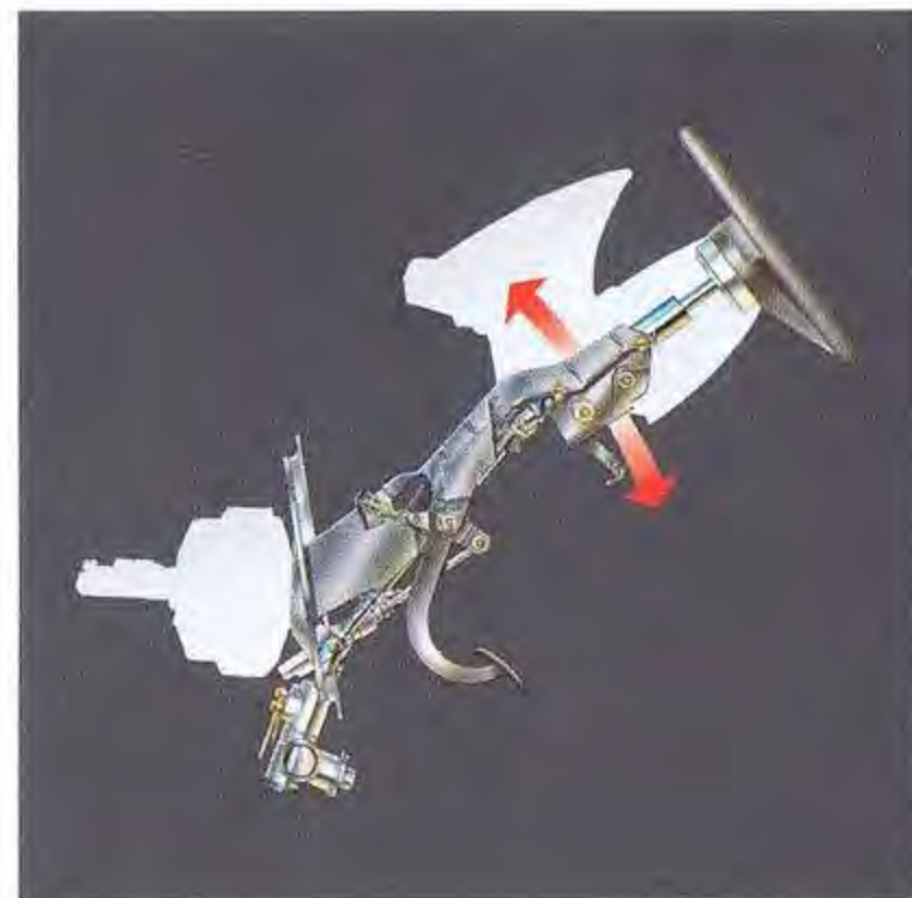
万一の衝突の際には、 衝撃を吸収するステアリングコラム。 角度の調節も可能。
