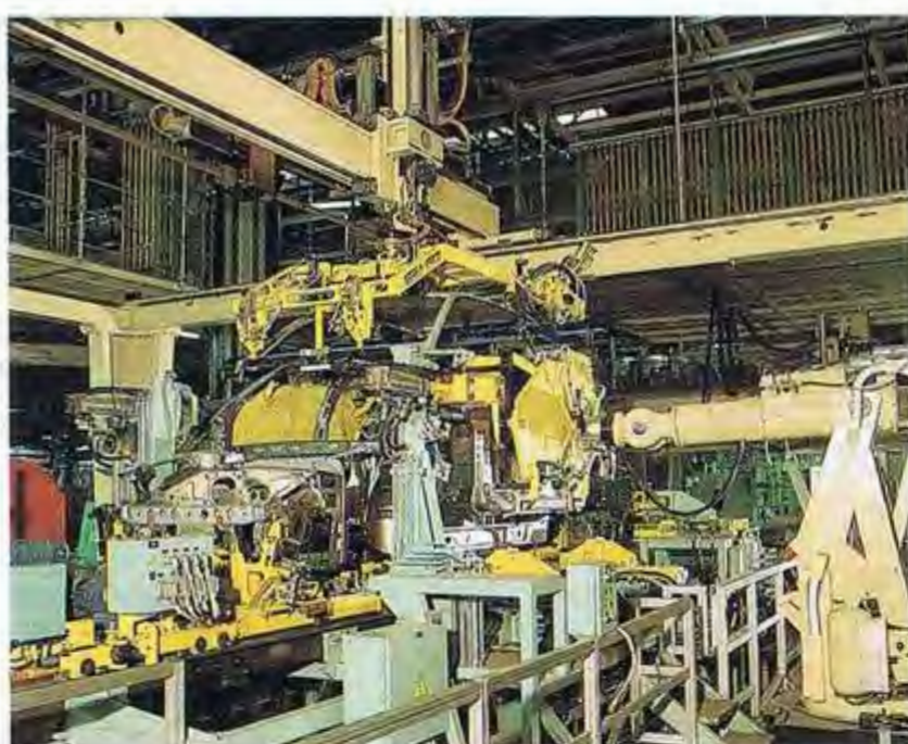
ロボットの導入によって、 精密なサイズ・チェックが行われます。 写真は車体のタック溶接の 様子です。
