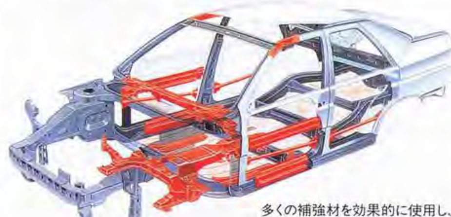
多くの補強材を効果的に使用し、優れた剛性を実現したボディ。
