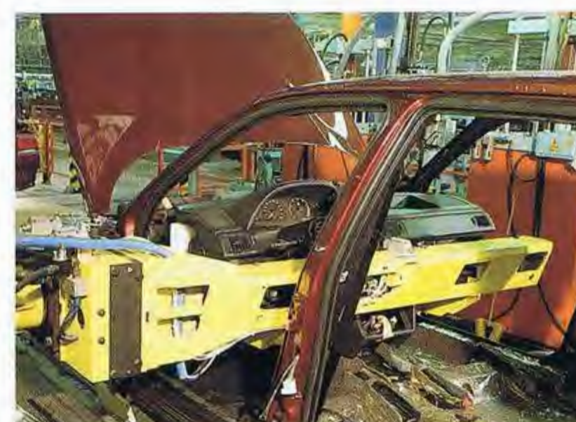
フロントパネルはロボットによって 自動的に取り付けられます。
