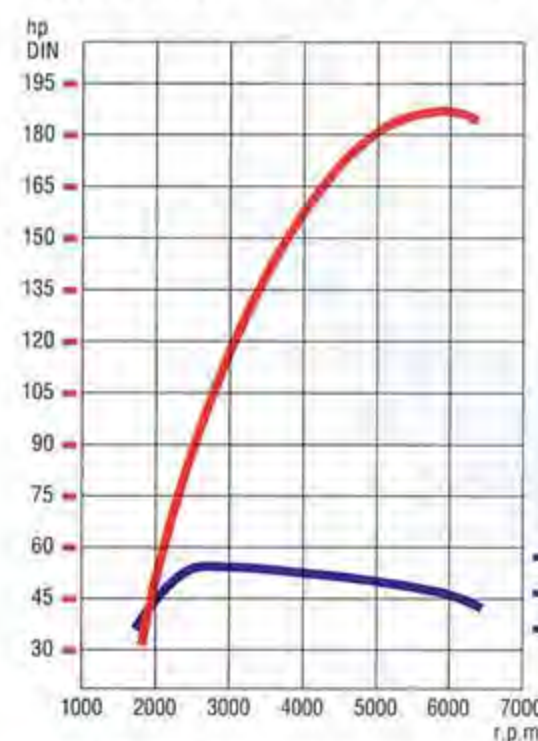
直列4気筒2.0 DOHC16バルブ・インタークーラーターボ・エンジンの性能曲線およびトルク曲線。
