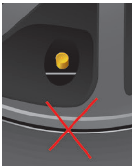
Неправильное положение края декоративного колпака.
