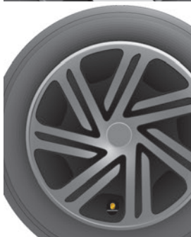
Неправильное положение края декоративного колпака.
