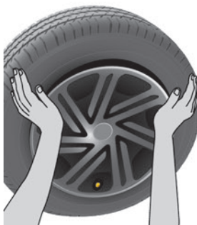
Неправильное положение края декоративного колпака.
