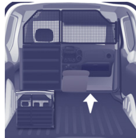
Trennwand mit Klappe
