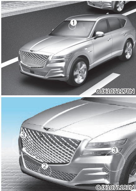
①: 전방 카메라, ②: 전방 레이더, ③: 전측방 레이더(사양 적용 시)
