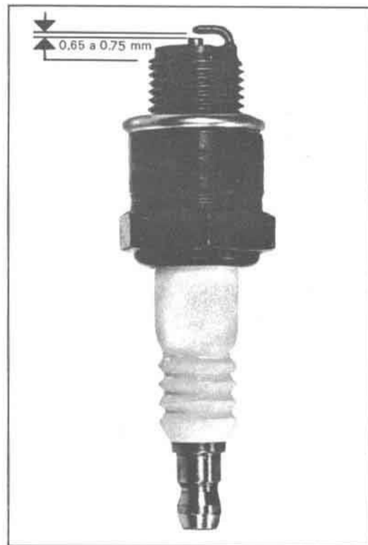
Fig. 44 - Separación de los electrodos
