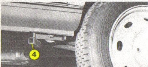
Fig. 36 - Sustitución de una rueda 4 - Alojamiento de introducción de la gata
