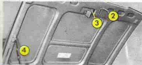
Fig. 7 - Capot 2 - Seguro 3 - Picaporte 4 - Muletilla articulada de soporte
