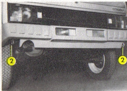
Fig. 51 - Remolcado trasero 2 - Argolla de fijación
