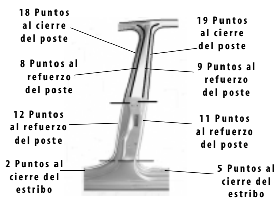
Figura 46 | Unión del poste central
