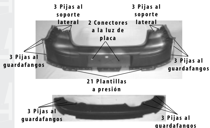
Figura 54 | Unión del conjunto defensa trasera
