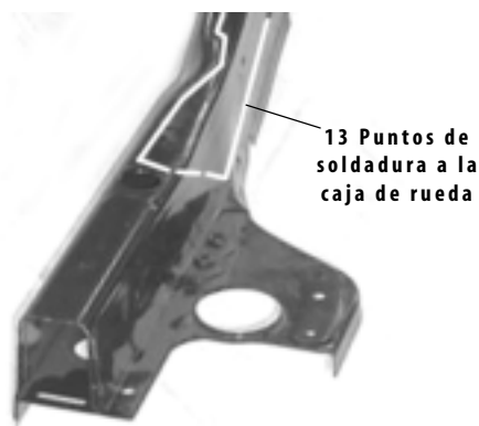
Figura 31 | Unión de la punta del larguero delantero
