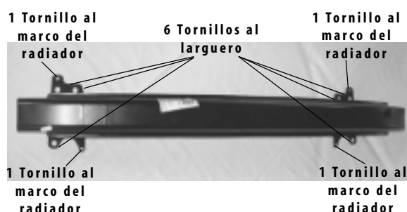
Figura 14 | Unión del alma metálica de la defensa delantera
