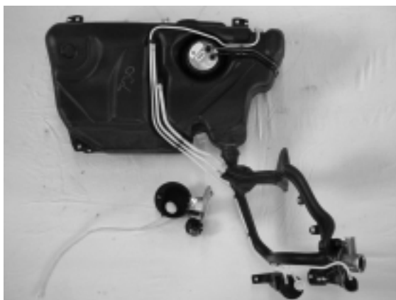
Figura 76 | Depósito de combustible
