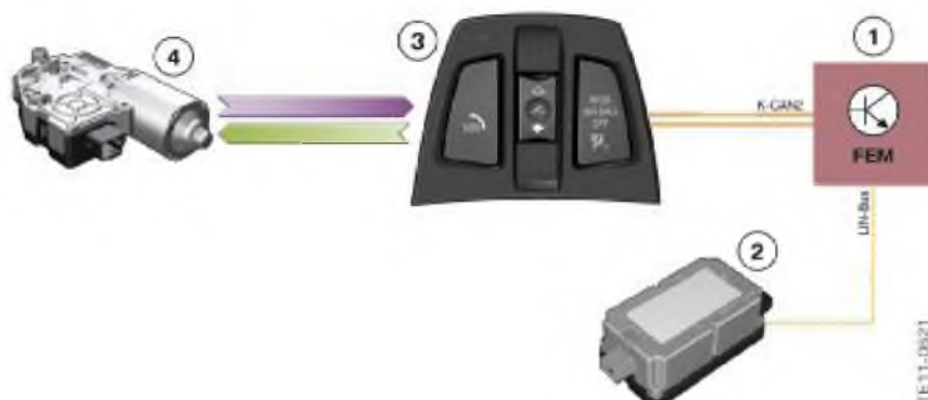
Входы/выходы люка со стеклянной подъемно-сдвижной крышкой
