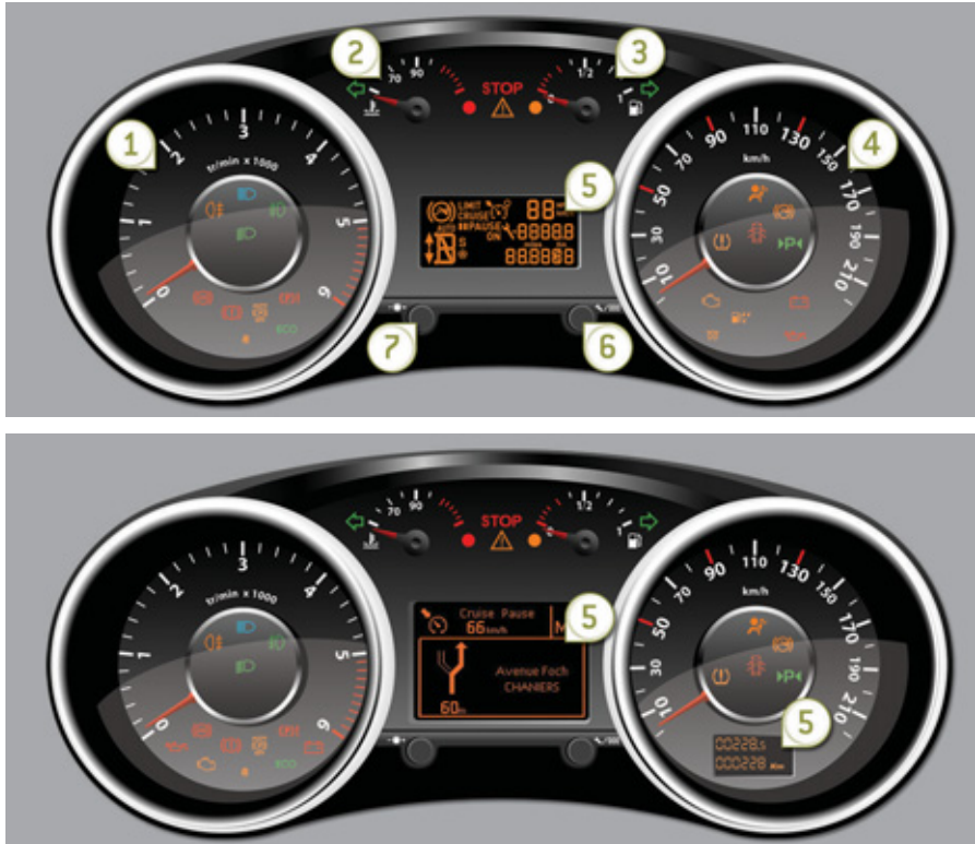
Oversigten viser displays og kontrollamper for bilens funktioner.
