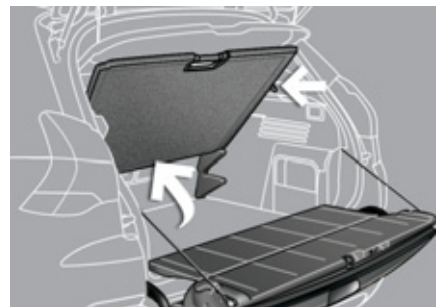
Fra høj position sættes bunden på skrå ved hjælp af de to stop i siderne for at få adgang til reservehjulet eller til opbevaringsrummene bagerst i bagagerummet.
