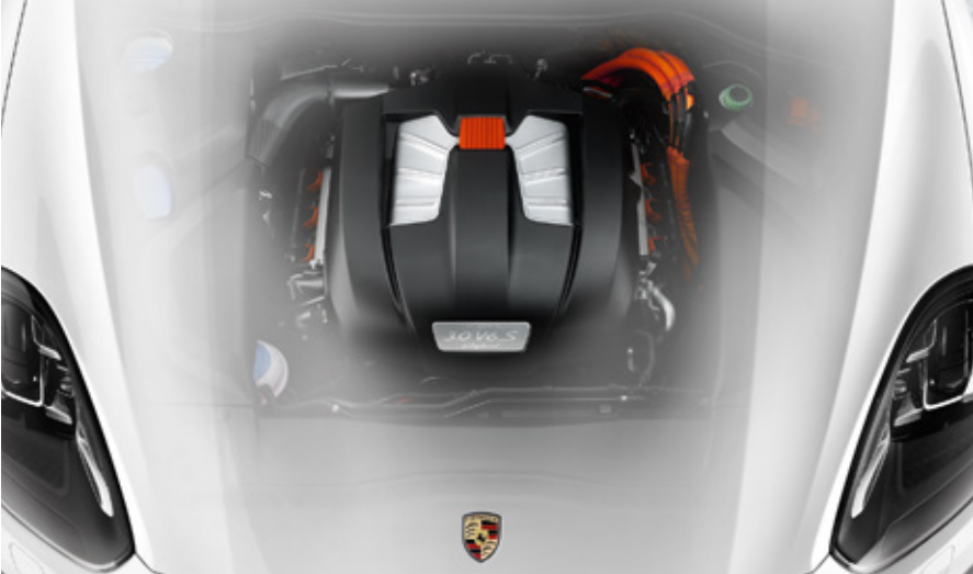
Cayenne S E-Hybrid total: 590 Nm entre 1.250 y 4.000 rpm, 306 kW (416 CV) a 5.500 rpm
