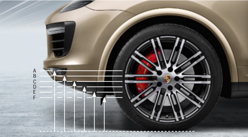
Suspensión neumática con PASM. Mayor dinámica y confort de conducción (página 56) 1)
