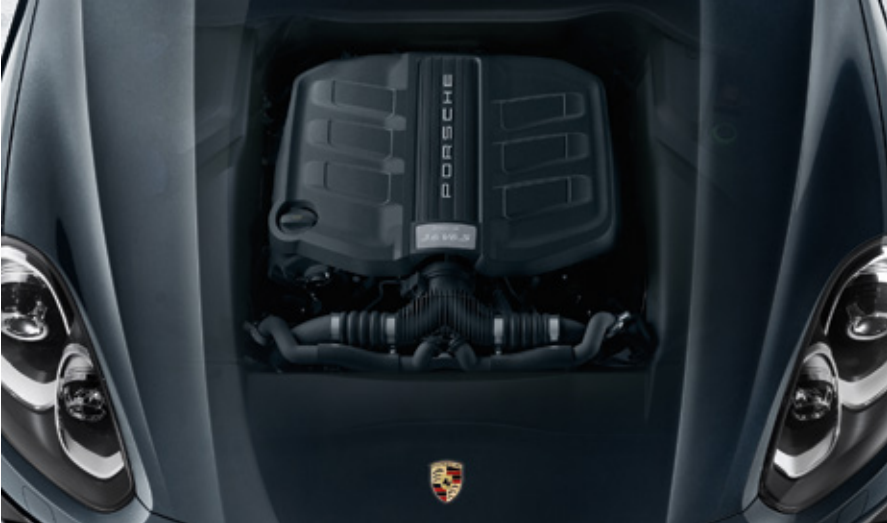
Cayenne S: 550 Nm entre 1.350 y 4.500 rpm, 309 kW (420 CV) a 6.000 rpm
