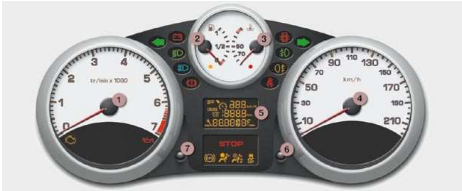
Tafel mit den Anzeige-/Messinstrumenten und Betriebskontrollleuchten des Fahrzeugs
