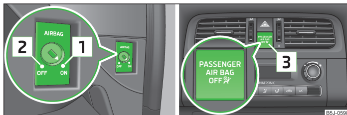
Rys. 119 Wyłącznik kluczykowy czołowej poduszki bezpieczeństwa pasażera / lampka kontrolna wyłączonych i włączonych czołowych poduszek bezpieczeństwa pasażera
