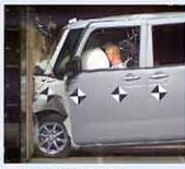
55km/h 前面衝突実験
